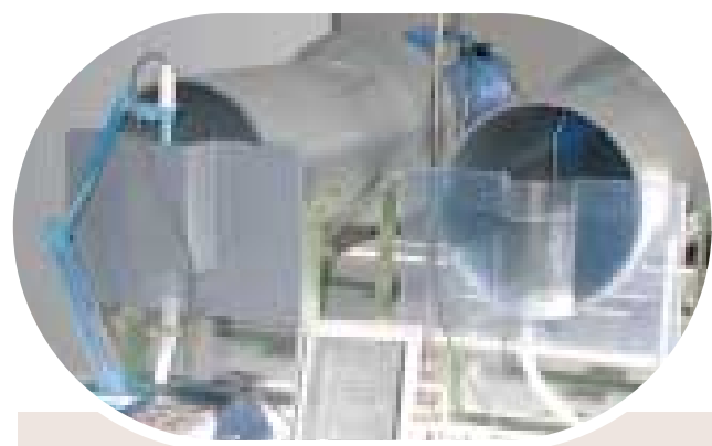
Deux tuyaux sont mis à l'essai pendant six mois consécutifs : l'un à PH3, l'autre à PH 11. (Test d'après la Norme EN 598)
